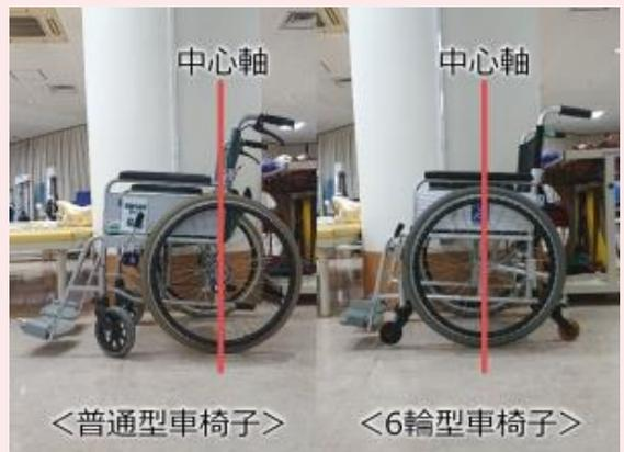
6輪型車椅子の駆動輪は普通型と比べてやや前方にあり、利用者のほぼ真横に位置しています。従来型車椅子であれば、駆動輪を前に付けるほど後方に倒れやすくなるため、利用者よりもやや後方についています。しかし6輪型では前後のキャスターが転倒を防いでくれるため、駆動輪の位置は構造上の制約を受けず、自由度が高いのです。
